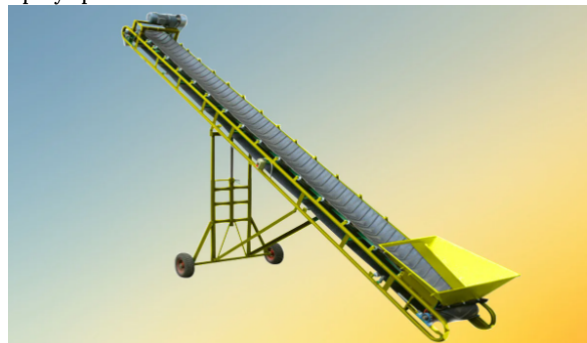
Рис.1. Ленточный передвижной конвейер
