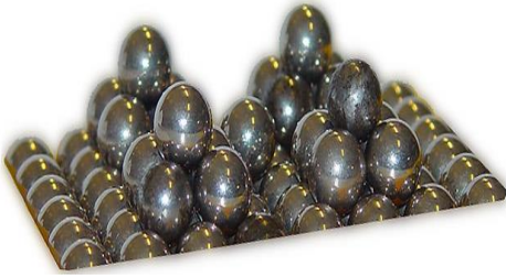
Рис. 2. Модель расположения атомов в кристалле объемноцентрированной кубической структуры
